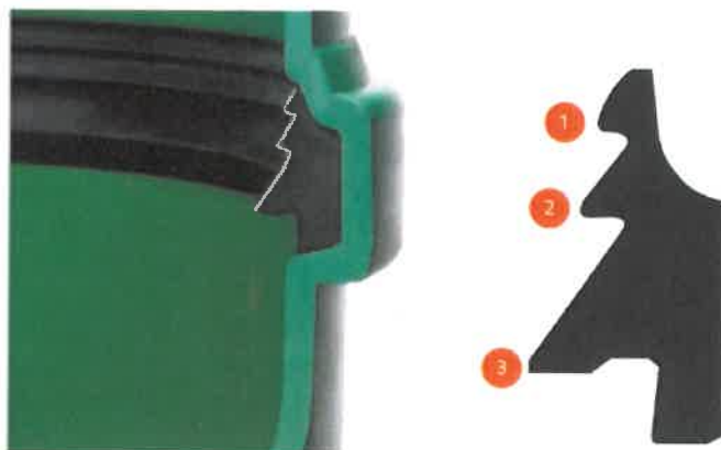
Rys. 14 Uszczelnianie połączeń kielichowych za pomocą pierścienia uszczelniającego 1 – krawędź napinająca i przytrzymująca, 2 – krawędź zgarniająca, 3 – krawędź uszczelniająca
