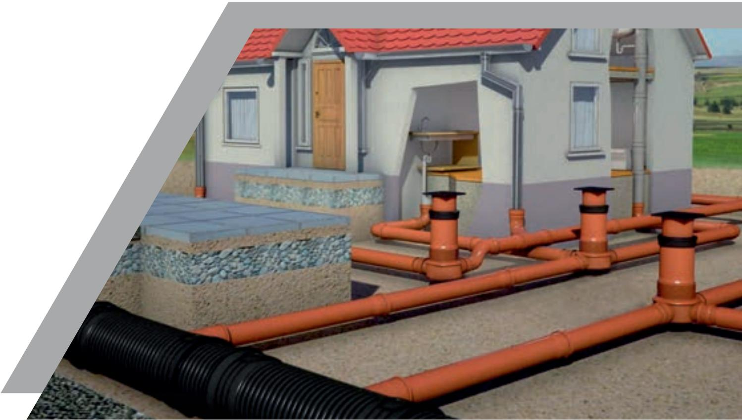
Vamzdžiai yra gaminami SN8 (8kN/m<sup>2</sup>) standumo klasės, 3 ir 6 metrų ilgio. MAGNACOR sistemos vamzdžių ir jungiamųjų detalių išorinė sienelė yra juodos spalvos, vidinė sienelė – šviesiai pilkos spalvos. Lygus vidinis šviesiai pilkos spalvos paviršius suteikia gerą matomumą naudojant TV kamerą atlikti tinklų tikrinimo darbus.
