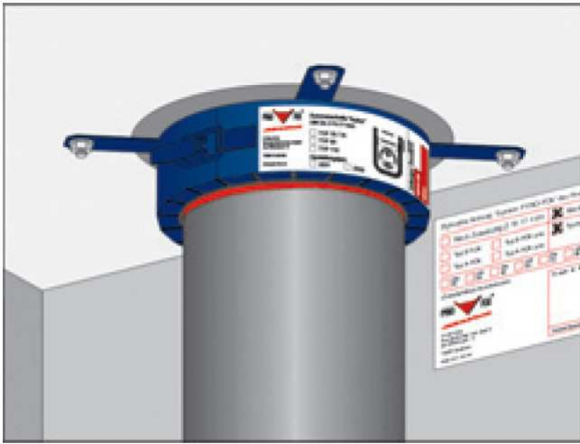
Tiesimas per perdangą - kaiščiiais pritvirtinta mova
